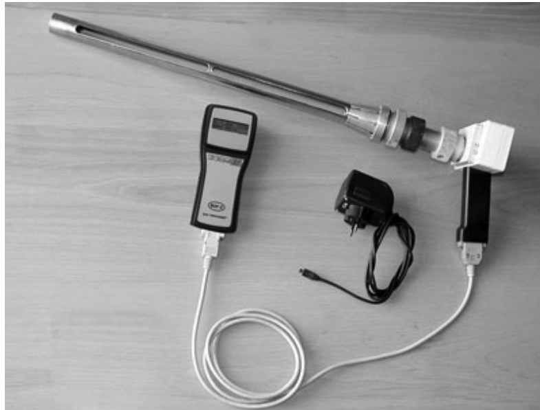
Рис. 2. Внешний вид и комплект поставки пылемера ВОГ-2
