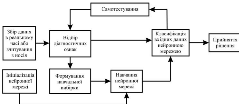
Рис. 1. Робота системи класифікації технічного стану об'єктів на основі багатошарового персептрона
