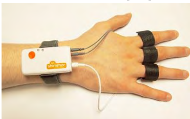
Рисунок 1. Фото сенсора Shimmer 3
