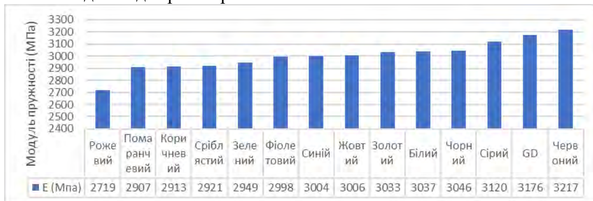
Рис. 2. Вплив кольору матеріалу на модуль пружності.
