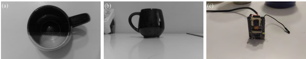
Рисунок 2. Приклад отриманих зображень з камери оптико-електронного модулю ESP32-CAM. (a) Зображення предмету, вид зверху 30 см. (b) Зображення предмету, вид з боку 30 см. (c) Зображення камери оптико-електронного модулю ESP32-CAM.
