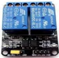
Рисунок 3. 2-канальний модуль реле [6]
