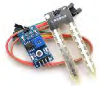
Рисунок 3 - Датчик вологості ґрунту (гігрометр) DAT136
