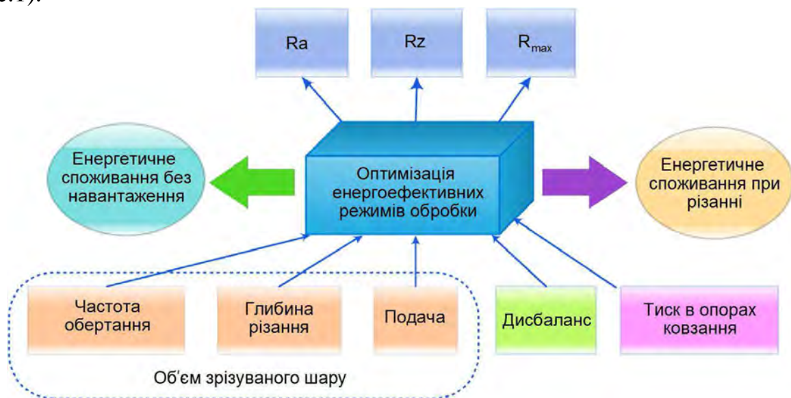
Рис. 1. Структура оптимізації процесу механічної обробки на верстаті з гідростатичними опорами шпинделя
