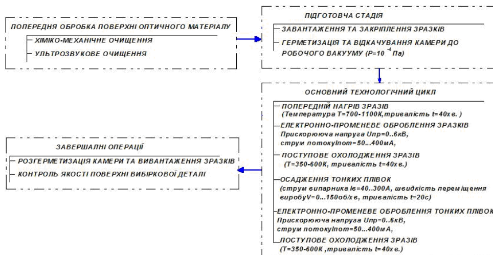
Рис. 1. Послідовність проведення комбінованого електронно-променевого оброблення оптичних матеріалів
