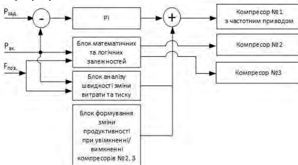
Рис. 1. Структурна схема головного регулятора системи керування мультикомпресорною установкою для одержання стисненого повітря
