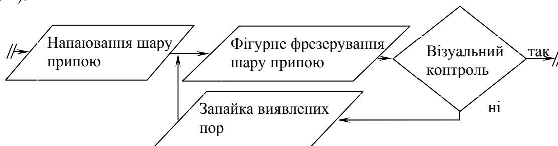
Рис. 1. Технологічний цикл «Фрезерування – візуальний контроль – запайка»
