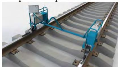
*Рис. 1. Разработанная модель конструкции тележки*
