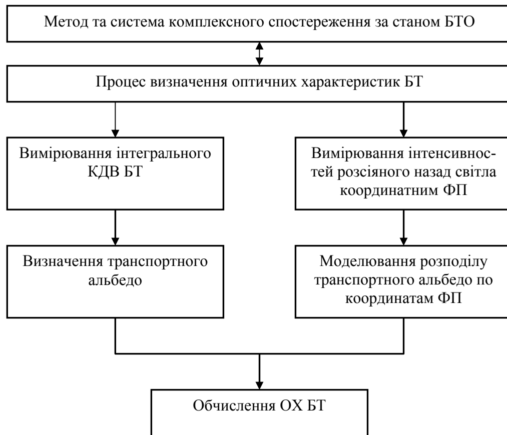
Рисунок 3 – Структурно-алгоритмічна реалізація процесу визначення оптичних характеристик біологічних тканин з використанням методу та системи комплексного спостереження за станом БТО
