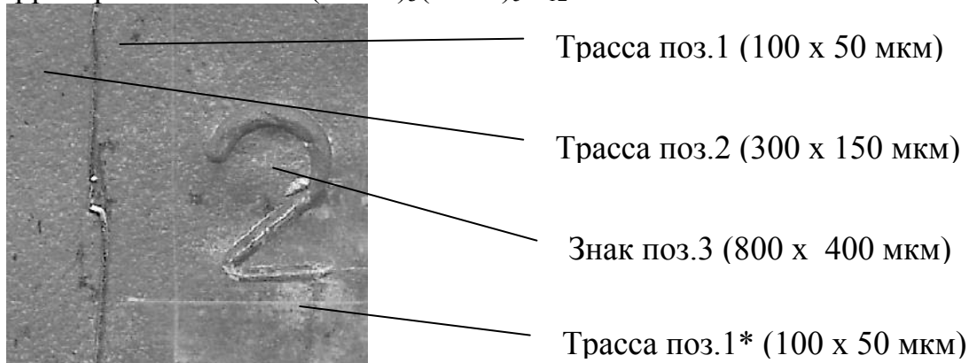
Рисунок 1 – Тест-объект, содержащий рельефные трасы и знаки (фотографическое изображение поверхности)
