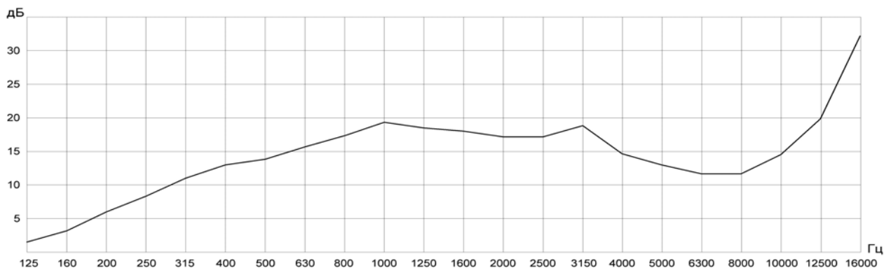
Рис. 1. Акустичні характеристики трубопроводу в ППУ ізоляції
