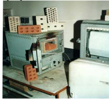
Рисунок. Електрична піч опору з терморегулятором
