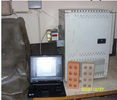
Рисунок. Електрична піч опору з терморегулятором
