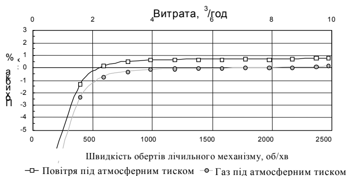
Рисунок 1. Аналітичні криві похибок лічильника РЛ 6 при його роботі на повітрі, побудовані на основі математичної моделі необліковуваних перетоків у його щілинних зазорах.
