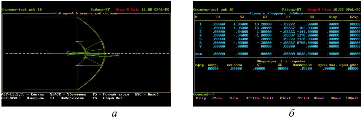
Рис. 1. Афокальная зеркальная система: а – схема хода лучей; б – суммы Зейделя.
