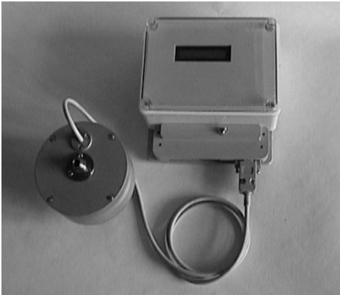
Рисунок 3 – Зовнішній вигляд експериментального зразка автоматичного рефрактометра
