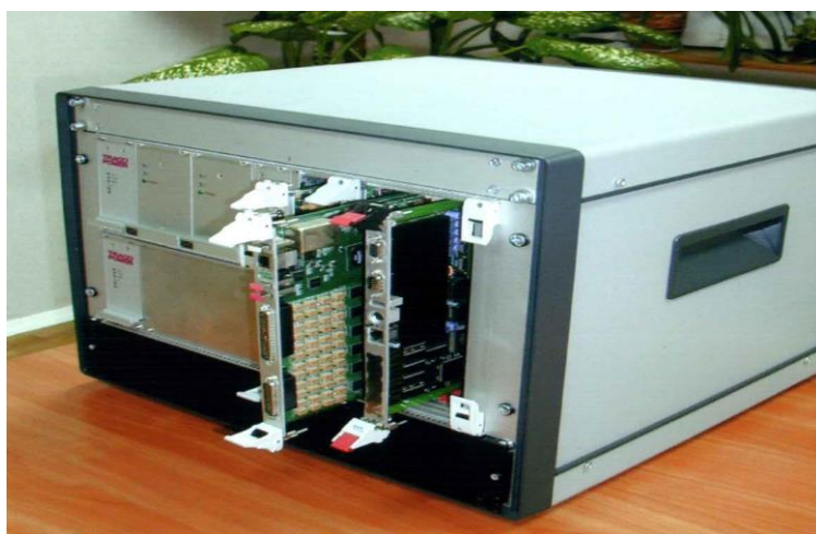
Рис. Електронний блок управління ультразвуковими лучами та цифрової обробки сигналів.
