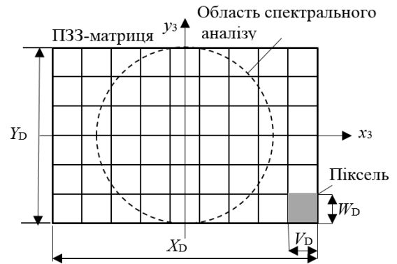
Рисунок 5 – Площина спектрального аналізу когерентного спектроаналізатора
